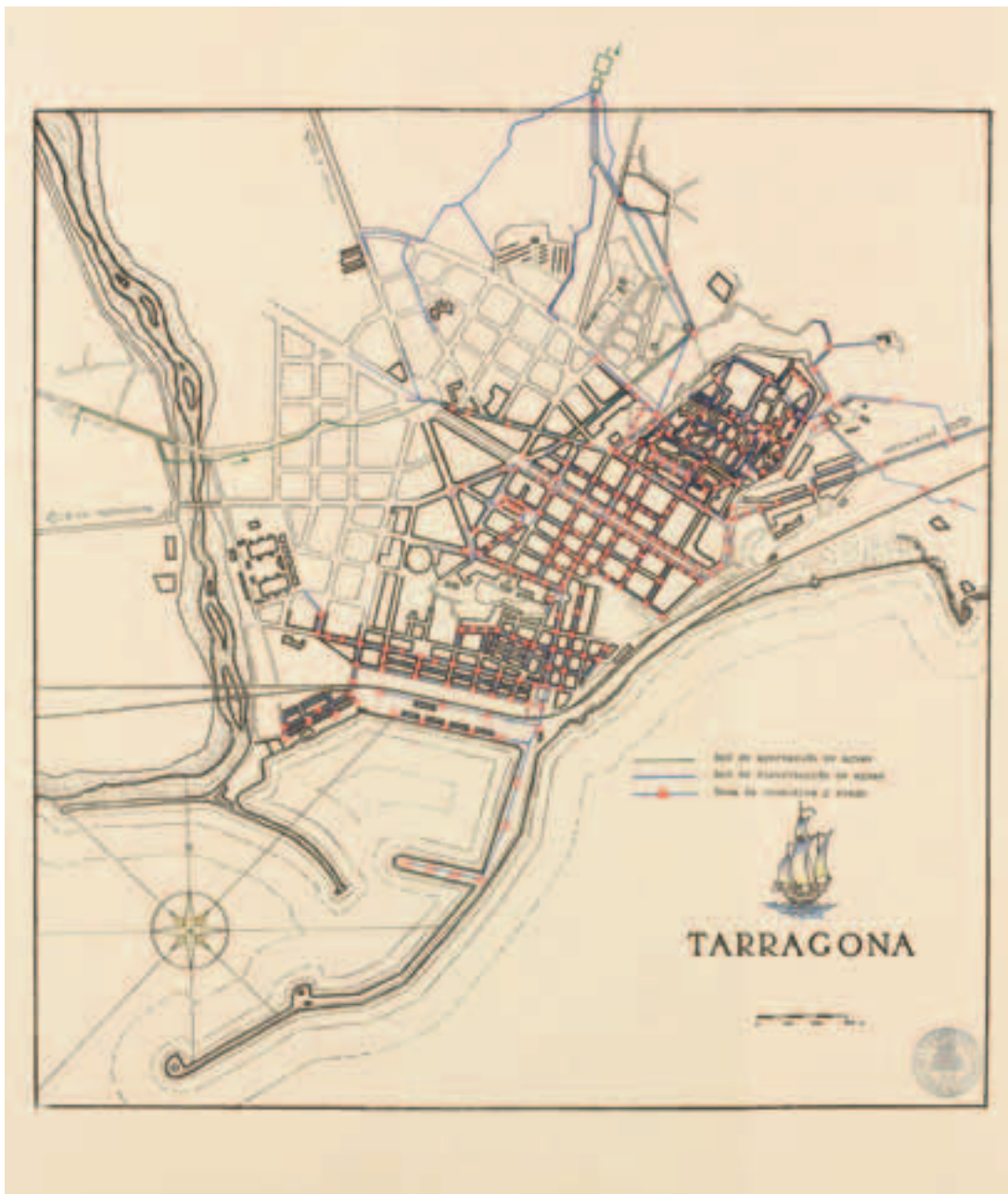
Plànol de la ciutat amb la xarxa d'aportació i distribució d'aigües i les boques d'incendis i reg, any 1952.
