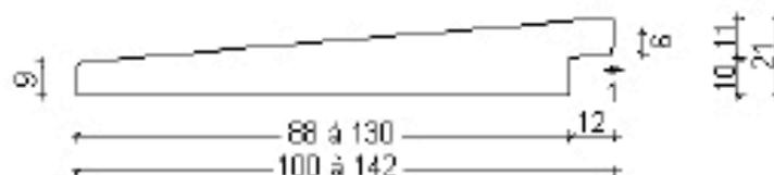
Figure 2ter - Profil UYL – Mi-bois – 21 x 142 mm (largeur utile : 132 mm)
