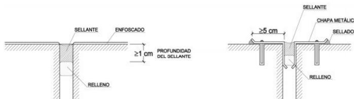
Figura 2.6 Ejemplos de juntas de dilatación
