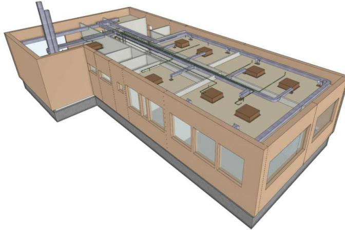
Vista esquemática de instalaciones en planta baja.
