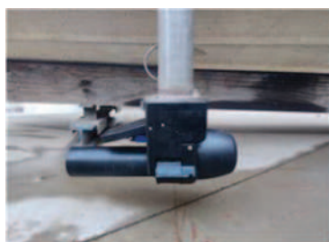
Figura 4.- Detall del eix i la estructura de la sonda, instal·lada al casc lateral de l'embarcació.
