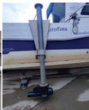
Figura 4.- Detall del eix i la estructura de la sonda, instal·lada al casc lateral de l'embarcació.
