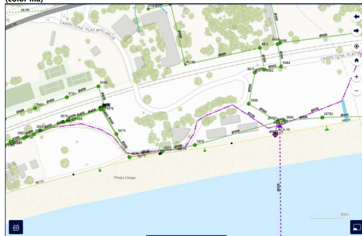
Línia clavegueram (color verd), línia de reg (color groc), línia impulsó aigua residual (color lila)
