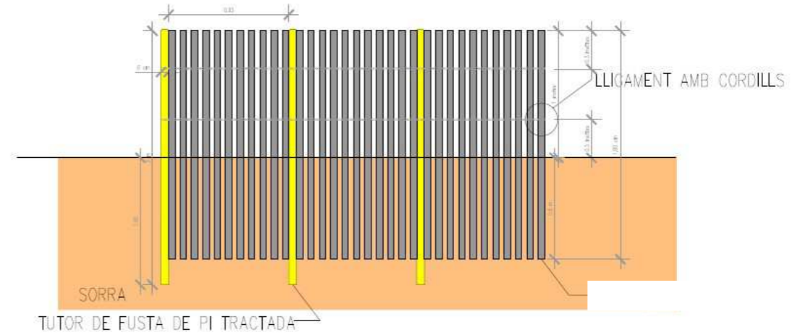
Figura 10. Disseny d'elements retenidors de sorra
