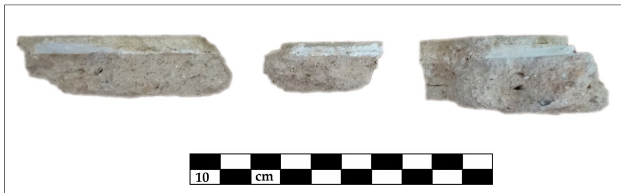
Figura 2. Mortero de los fragmentos del conjunto 1, con capa intermedia de estuco.
