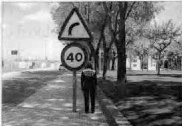
Señal que por su altura y tamaño puede comportar peligro para los peatones que pasan por la acera. FOTO: DT
